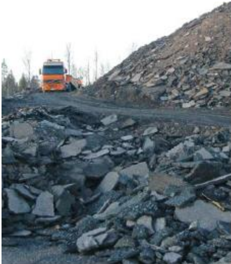
See pole mingi prügila, nagu eespool tekstiski kinnitatakse. Siin on suurte kuhilatena ladustatud asfaldimurd (jämepeurustatud asfalt).
